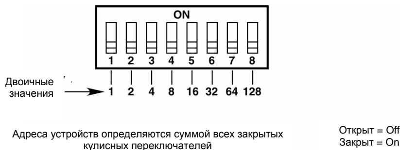
Рис. 18. Установка адресов извещателя X5200
