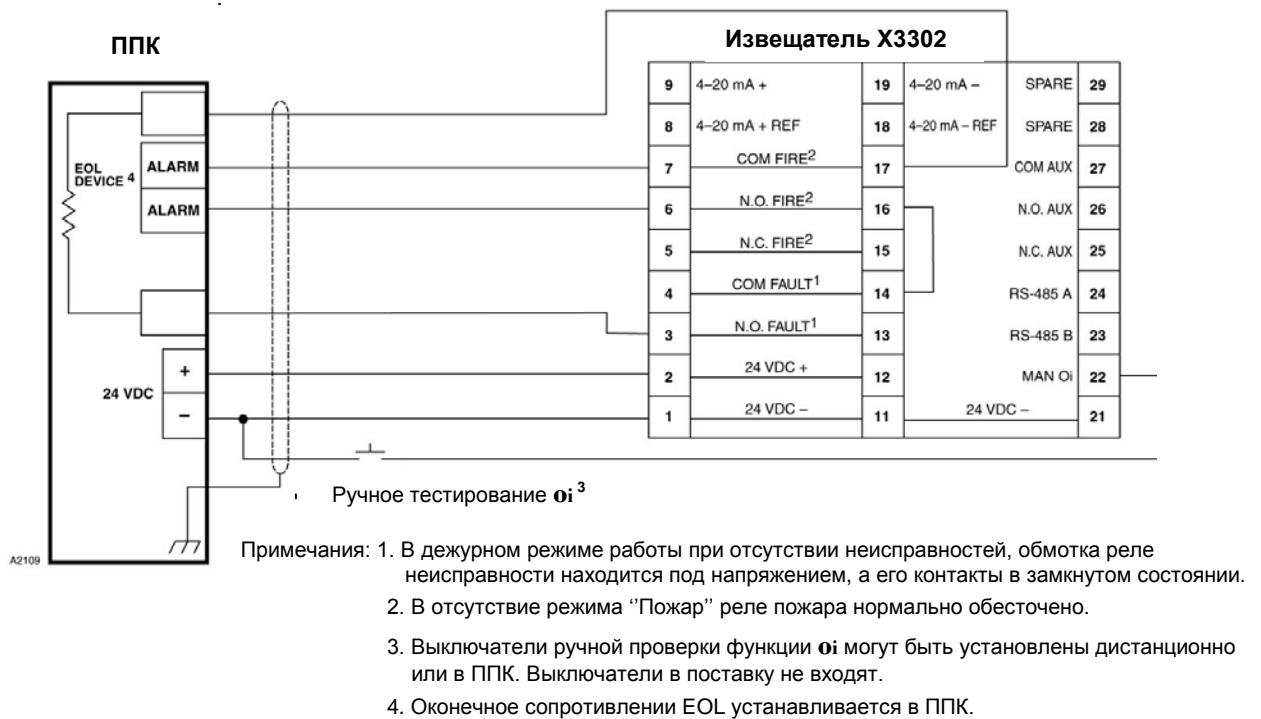
Рис. 9. Пример схемы подключения извещателя во взрывозащищённом исполнении Exde.
