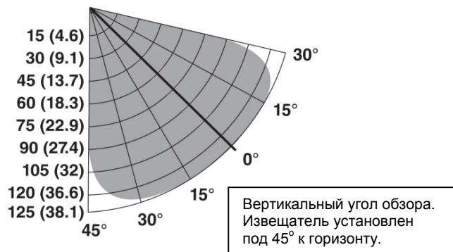
Угол обзора для пропана (факел 76 см) при очень высокой чувствительности
