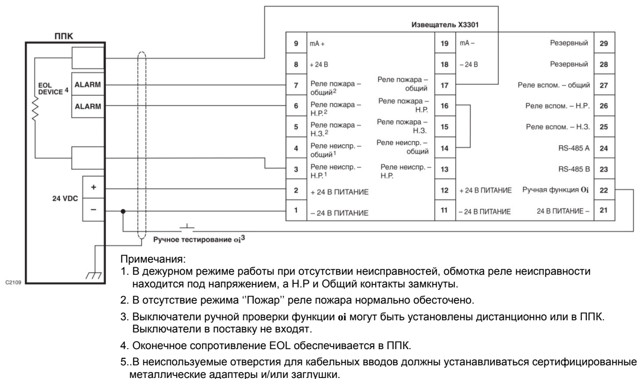
Рис. 9. Пример схемы подключения извещателя во взрывозащищённом исполнении Exde.
