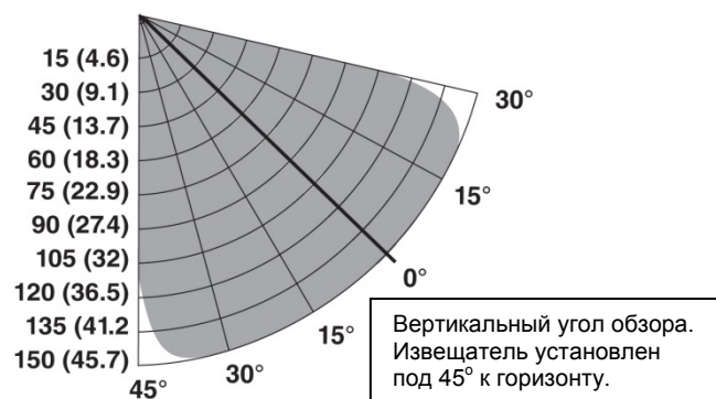
Угол обзора для метанола (0,3 x 0,3 м) при очень высокой чувствительности
