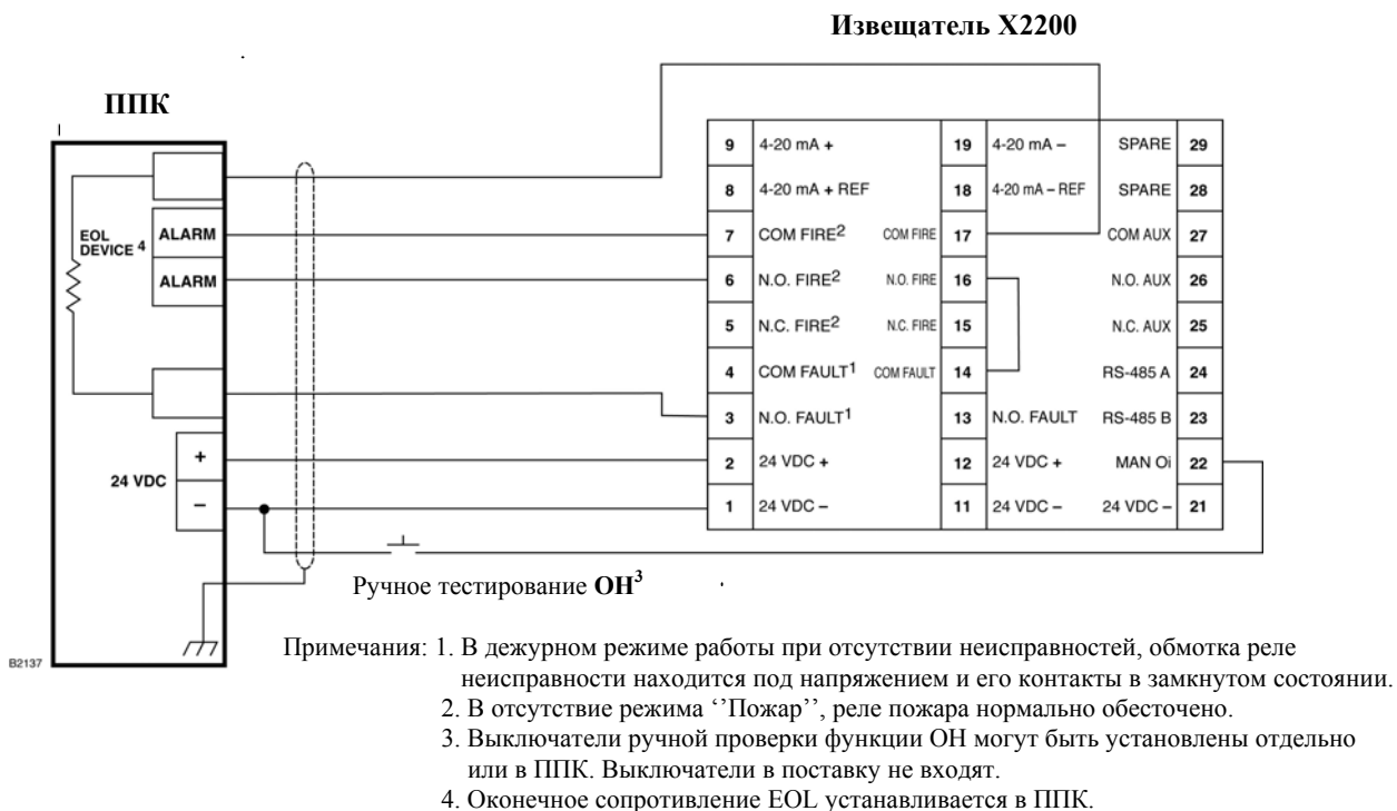
Рисунок 8 – Пример схемы подключения извещателя во взрывозащищённом исполнении повышенной надежности EEx de.
