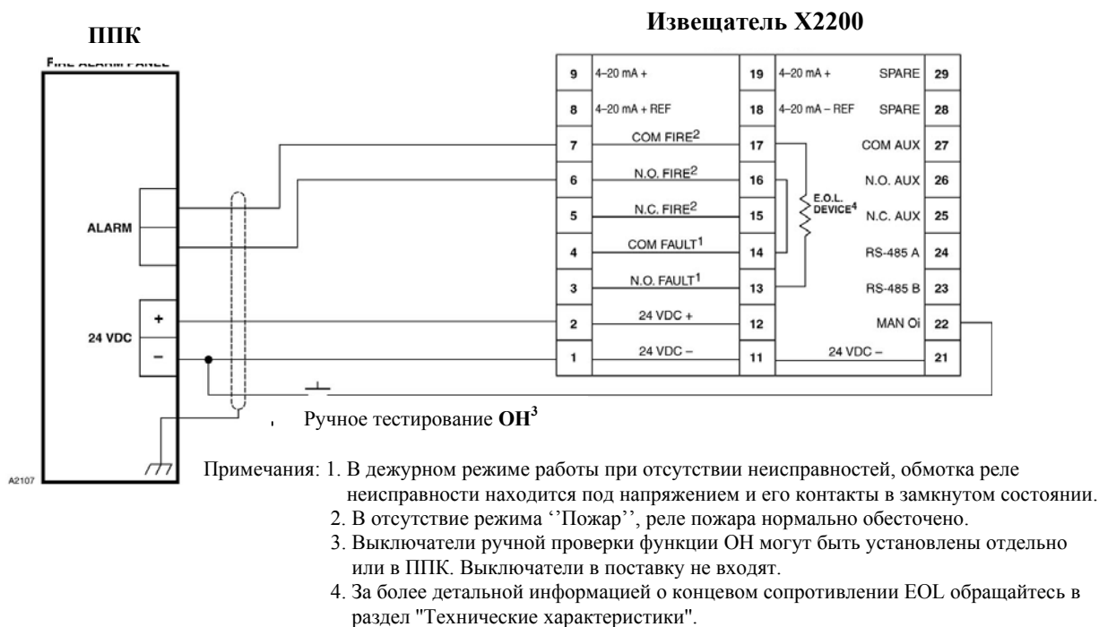
Рисунок 7 – Пример схемы подключения извещателя во взрывозащищённом исполнении EEx d.
