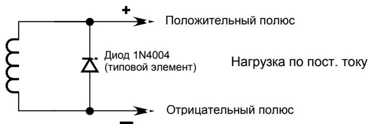
Рис. 4. Подавление переходных процессов в индуктивных нагрузках.
