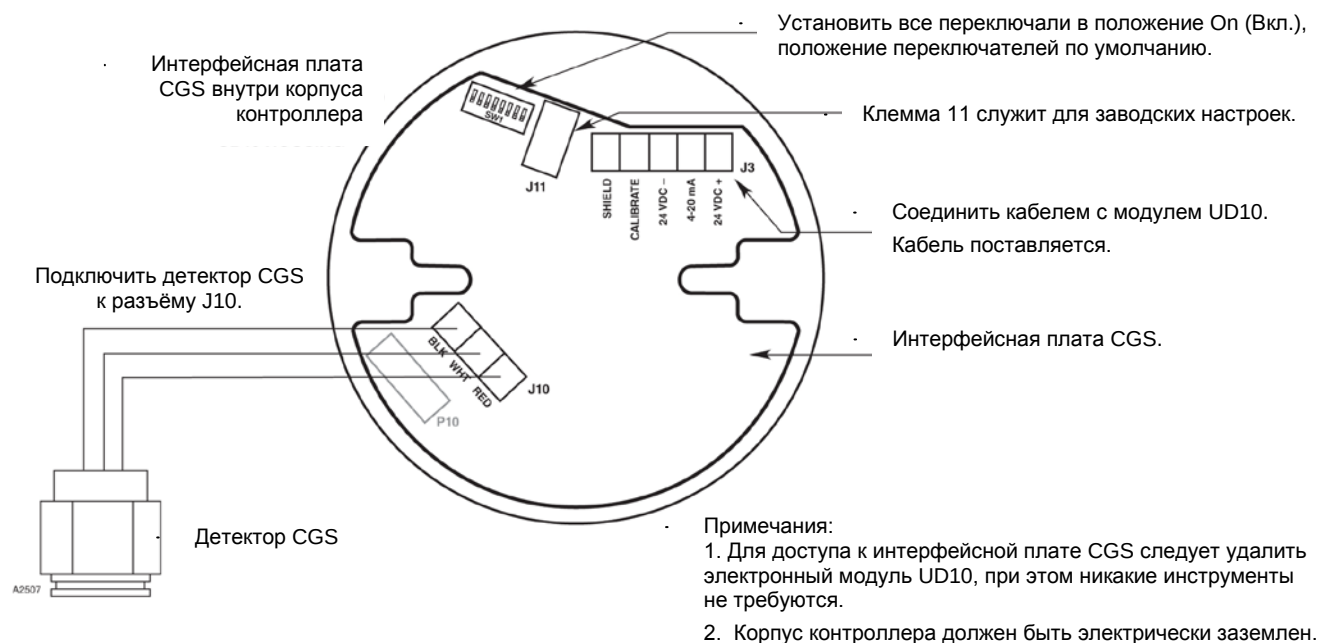
Схема подключения детектора CGS непосредственно к контроллеру UD10-DCU.
