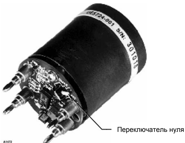
Рис. 20. Чувствительный элемент электрохимического датчика кислорода.
