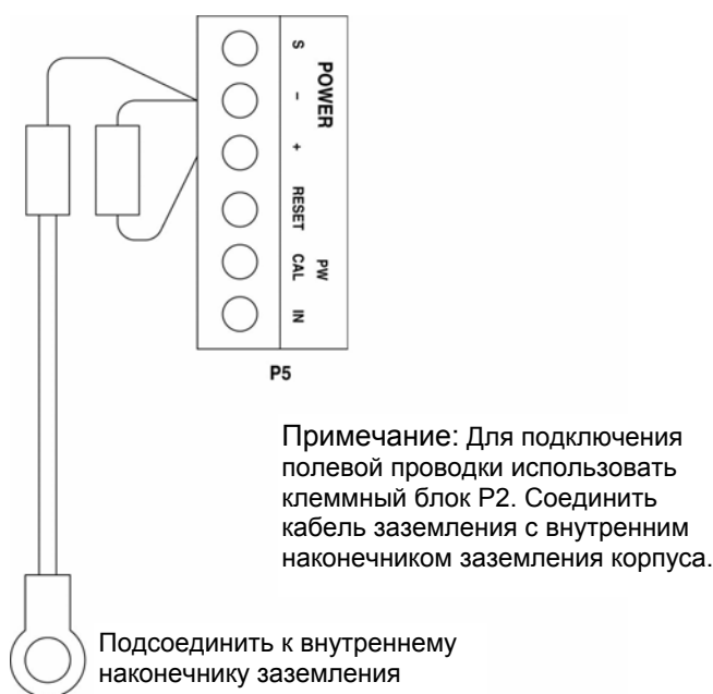
Рис. 12. Цепь подавления переходных процессов для оборудования категории 2. Соответствует требованиям директивы АТЕХ.
