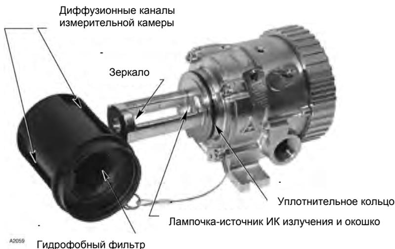
Рис. 22. Газоанализатор PIRECL со снятым всепогодным экраном.
