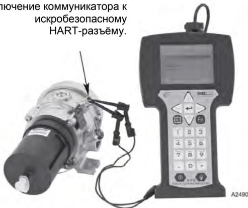
Рис. 20. HART-коммуникатор, подсоединенный к HART-разъёму газоанализатора.
