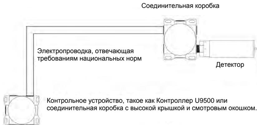
Рис. 21. Вариант дистанционной установки детектора PIR9400.
