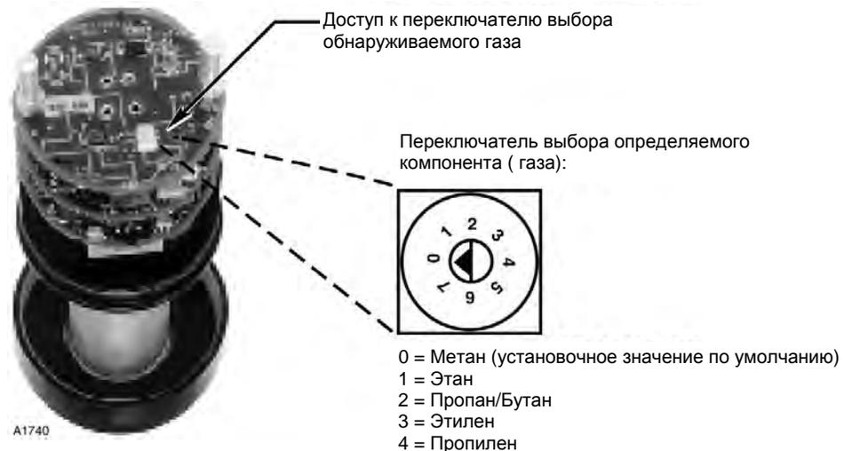
Рис. 14. Расположение переключателя выбора определяемого газа внизу электронного блока.
