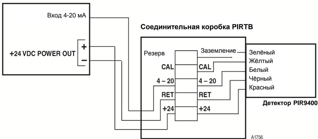
Рис. 16. Типовая схема подключения детектора PIR9400 с использованием соединительной коробки PIRTB.
