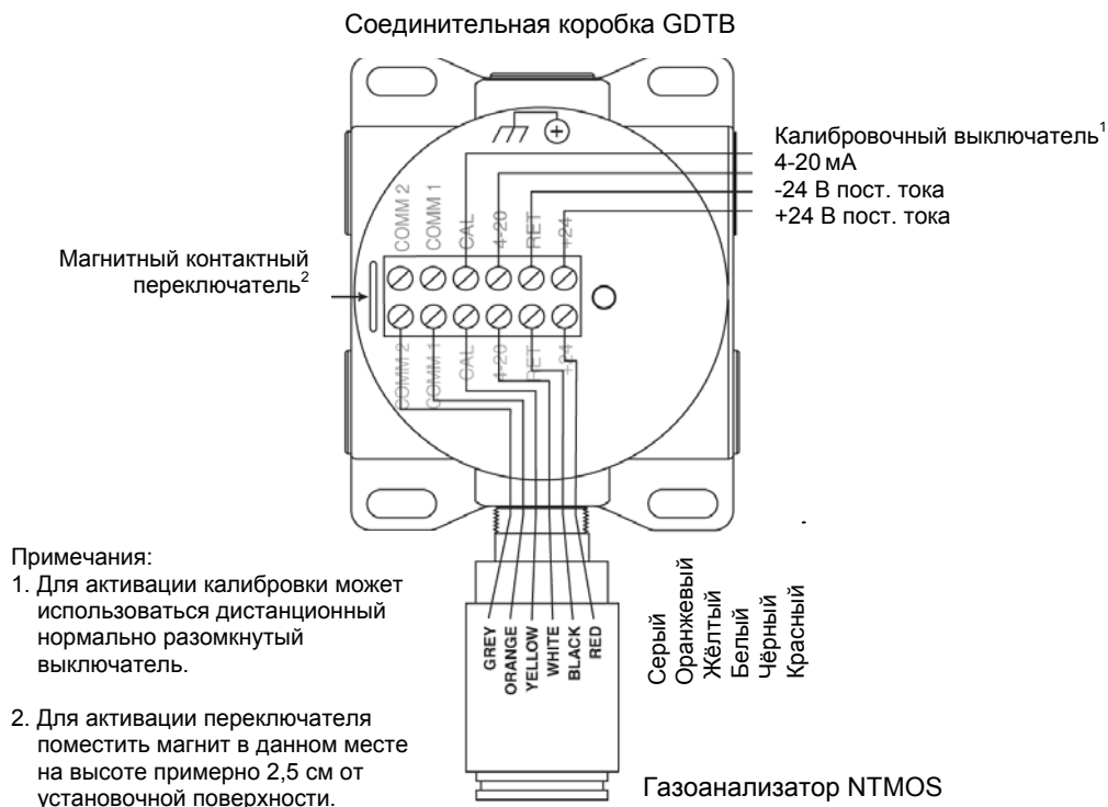
Рис.2. Газоанализатор NTMOS, подключённый через соединительную коробку GDTB.
