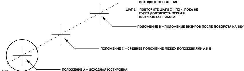
Рис. 27 — Юстировка LS2000 с использованием телескопического устройства для юстировки
