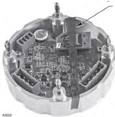
Лента устанавливается только на время транспортировки. Удалить ленту перед установкой модуля.
