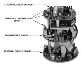
**CORRECT ORIENTATION OF TRANSMITTER BOARD**
