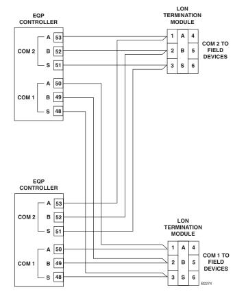
NOTE: LON TERMINATION JUMPERS P25 AND P26 (SEE FIGURE 3-12) MUST BE IN POSITION 2 AND 3 FOR REDUNDANT CONFIGURATION (ON BOTH CONTROLLERS).
