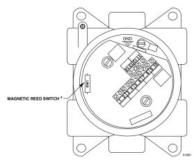
\* TO ACTIVATE THE MAGNETIC REED SWITCH, HOLD THE CALIBRATION MAGNET AGAINST THE SIDE OF THE ENCLOSURE AT THE LOCATION OF THE REED SWITCH, APPROXIMATELY ONE INCH ABOVE THE MOUNTING SURFACE.
