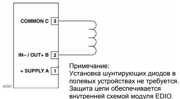
Рис. 3-33. Конфигурация выходной цепи без контроля.
