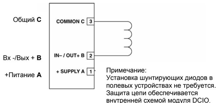
Рис. 3-43. Конфигурация выходной цепи с контролем автоматического пуска реагента.
