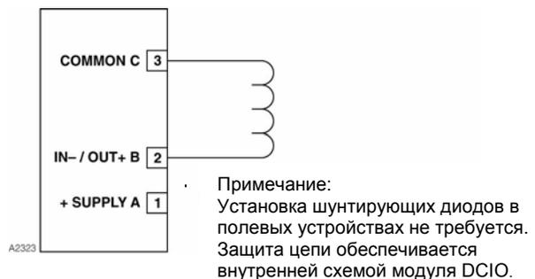
Рис. 3-44. Конфигурация выходной цепи без контроля
