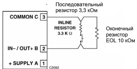
Рис. 3-29. Конфигурация входной цепи с контролем на обрыв и короткое замыкание (класс В).
