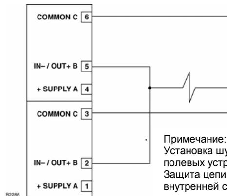
Рис. 3-37. Конфигурация выходной цепи с контролем пуска огнетушащих веществ (класс А).
