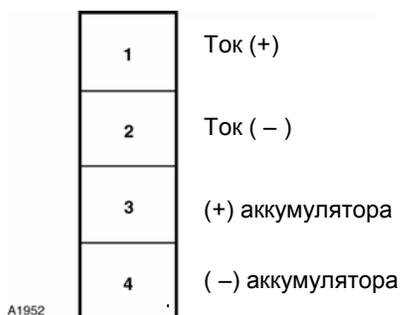
Рис. 3-22. Контрольные точки разъёма J2
