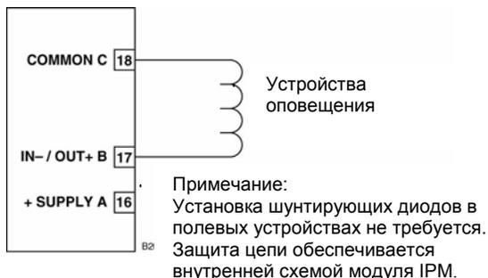
Рис. 3-57. Канал 6 - конфигурация выходной цепи без контроля.
