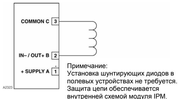
Рис. 3-59. Каналы 7 и 8 - конфигурация выходной цепи с контролем пуска огнетушащих веществ.
