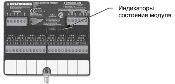
Рис. 4-6. Расположение индикаторов состояния аналогового модуля AIM.
