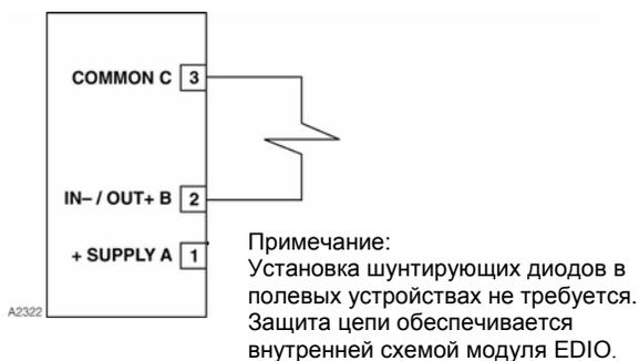
Рис. 3-36. Конфигурация выходной цепи с контролем пуска огнетушащих веществ.
