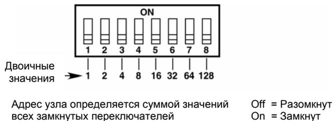
Рис. 3-72. Адресные переключатели модуля DCIO и релейного модуля.
