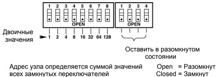
Рис. 3-71. Адресные переключатели модулей ARM, SAM, DCU и IDC
