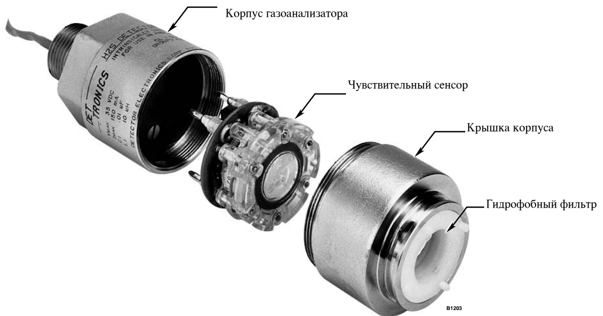
Рис. 6. Газоанализатор С7064Е, детализовка.
